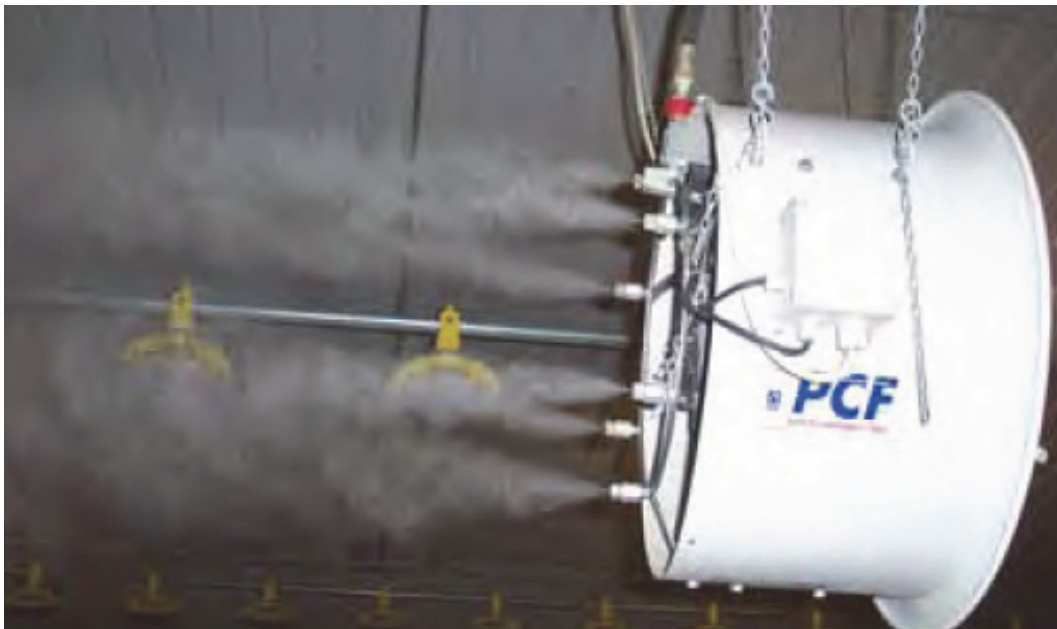
그림 1-14. 육추기간동안 상대습도를 증가시키기 위한 안개분무기의 사용
